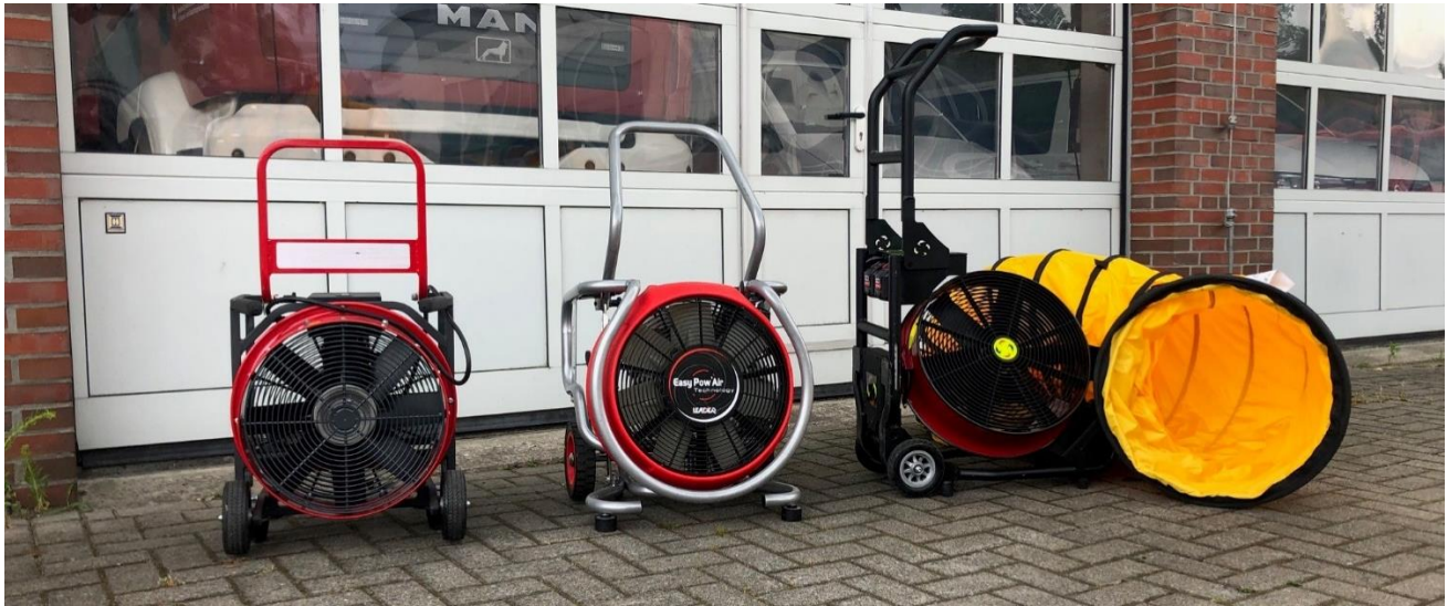
Turbolüfter (Elektro), Hochleistungslüfter (Verbrenner), Be- und Entlüftungsgerät (Akku)
