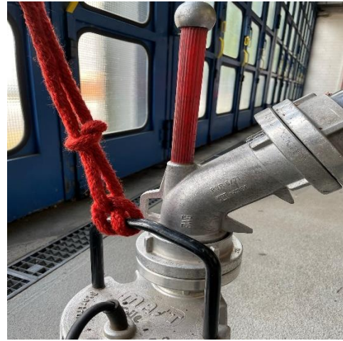
Sicherung der TP mit Mastwurf und Spierenstich
