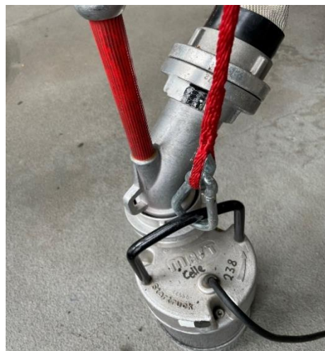
Linkes Bild: Sicherung mit Mastwurf und Spierenstich
